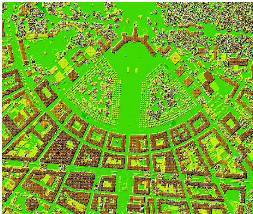
Bild: Digitales Oberflächenmodell der Stadt Karlsruhe (© Landesamt für Geoinformation und Landentwicklung Baden-Württemberg)
